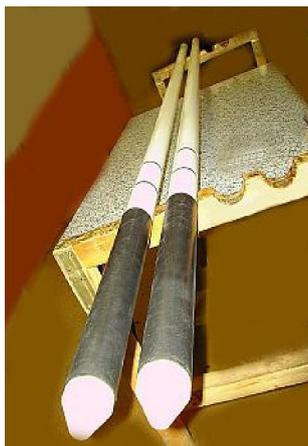
Предназначен для измерения кажущегося электрического сопротивления (КС) с переключением конфигурации зондов (градиент зонд – потенциал зонд), потенциала самопроизвольной поляризации (ПС) и мощности экспозиционной дозы (МЭД) гамма-излучения в скважинах на месторождениях урана. По заявке заказчика может оснащаться модулем магнитометрического инклинометра (модификация КСП-ГК-43И).
