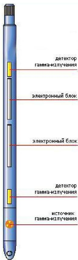
Предназначен для измерения мощности экспозиционной дозы (МЭД) естественного гамма-излучения и объемной плотности в геометрии  $4\pi$  при проведении исследований в скважинах комплексом методов гамма-каротажа (ГК) и гамма-гамма плотностного каротажа (ГГК-П) на рудных и угольных месторождениях.
