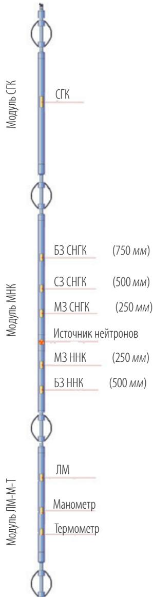
Рис. 1. Схема аппаратуры КСПРК-Ш-50-Т
