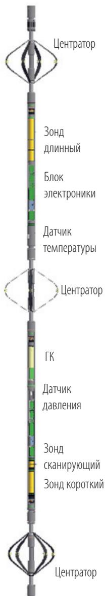
Рис. 4. Внешний вид аппаратуры МИД-4
