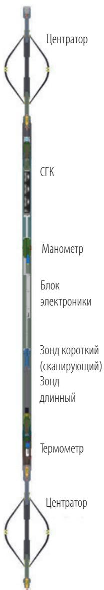
Рис. 2. Внешний вид аппаратуры МИД-С6
