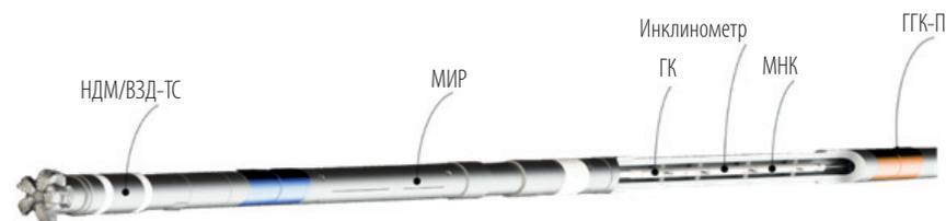
Рис. 1. Схема одного из вариантов компоновки геофизических модулей LWD производства ООО НПФ «ВНИИГИС-ЗТК»
