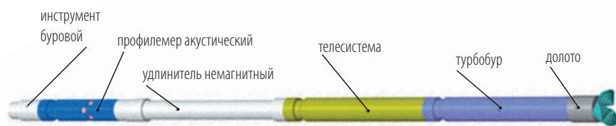
Рис. 7. Схема КНБК при опытно-промышленных работах
