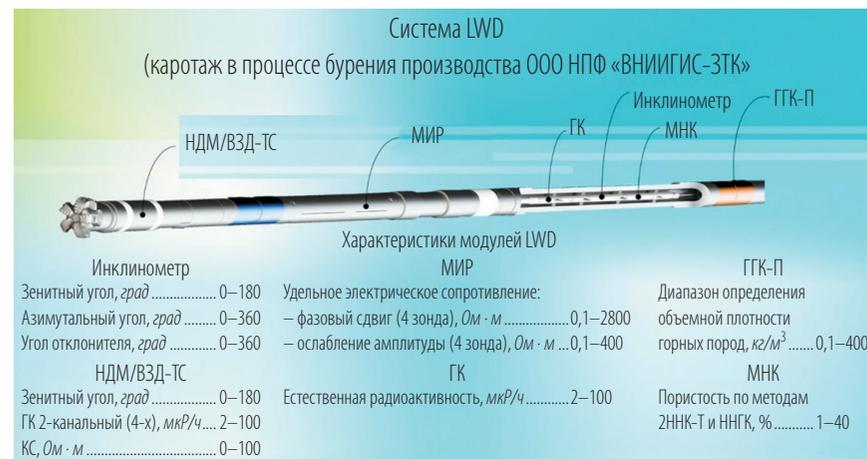
Рис. 5. Схема одного из вариантов компоновки геофизических модулей LWD производства ООО НПФ «ВНИИГИС-ЗТК» и их основные характеристики
