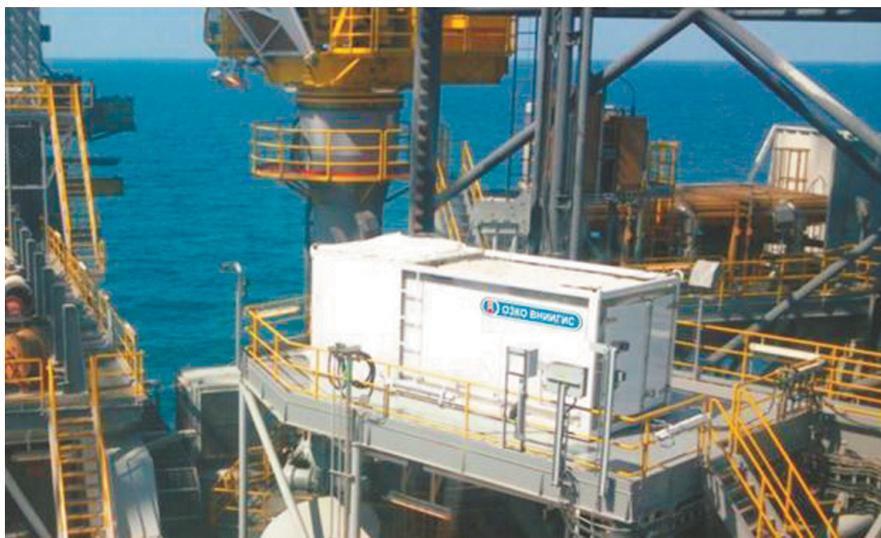
Рис. 1. Каротажный подъемник ПКН для работы на морской платформе
