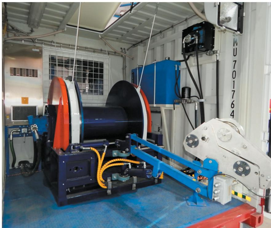
Рис. 2. Лебедка ЛПК с электрогидравлическим приводом и аварийным приводом от дизельного двигателя
