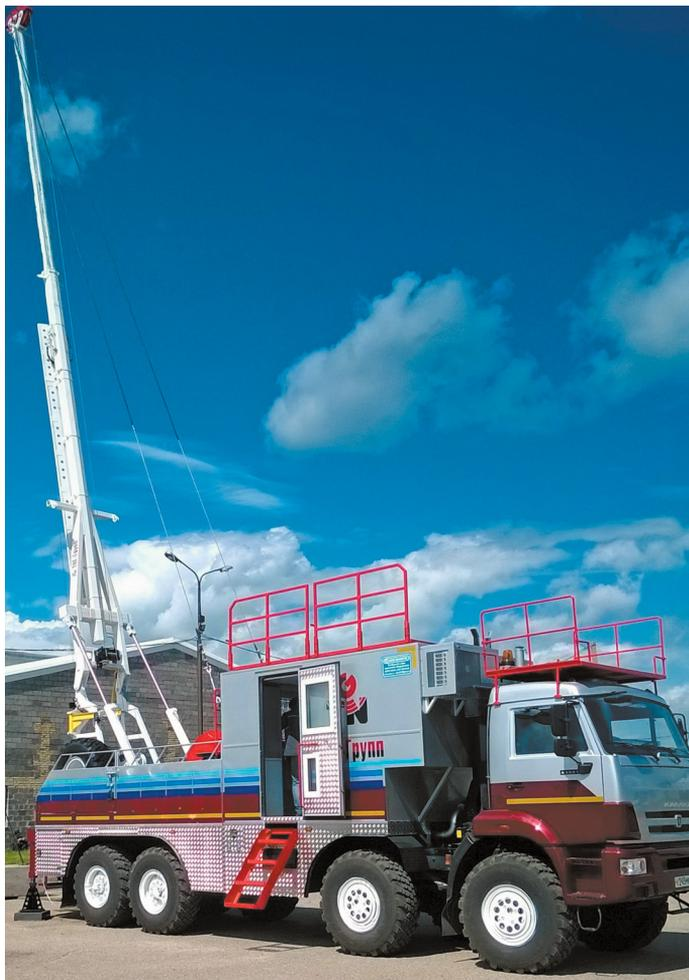
Рис. 3. Каротажный подъемник с телескопической мачтой
